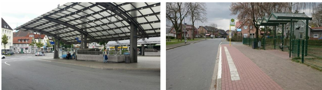
Abbildung 6: Beispiele für Haltestellen ohne bzw. mit unzureichendem taktilen Leitsystem (links: Recklinghausen Hbf; rechts: Haltern am See, Ehrenmal (Quelle: Kobra nvs GmbH))
