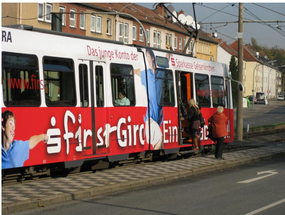
Abbildung 14: Straßenbahn-Haltestelle in Mittellage mit schmalen Bahnsteigen ohne Abschirmung zur Fahrbahn und ohne stufenfreien Einstieg ins Fahrzeug (Haltestelle „Pannschoppenstraße“, Stadtteil Horst)
