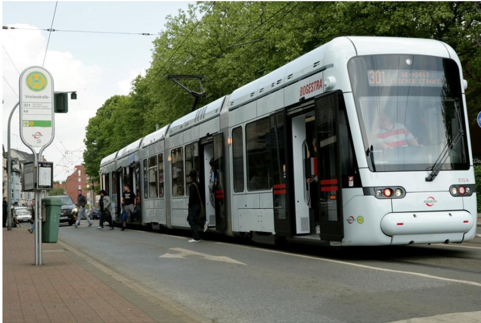
Abbildung 13: Straßenbahn-Haltestelle als „Fahrbahnhaltestelle“ mit Einsteigen vom Fahrbahnniveau (Haltestelle „Vinckestraße“, Stadtteil Buer); Sicherung des Fahrgastwechsels durch „Zeitinsel-LSA“
